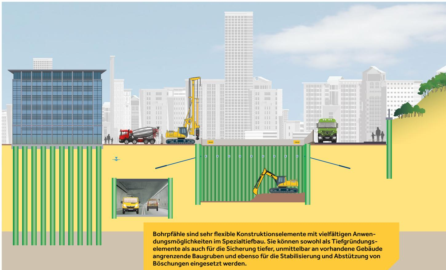
Bohrpfähle sind sehr flexible Konstruktionselemente mit vielfältigen Anwendungsmöglichkeiten im Spezialtiefbau. Sie können sowohl als Tiefgründungselemente als auch für die Sicherung tiefer, unmittelbar an vorhandene Gebäude angrenzende Baugruben und ebenso für die Stabilisierung und Abstützung von Böschungen eingesetzt werden.
