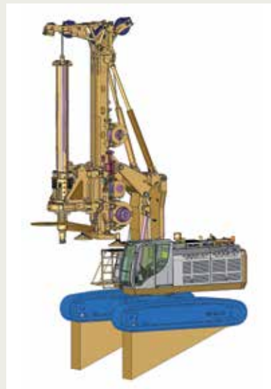
Prinzipdarstellung der Flächenpressung unter den Ketten eines Drehbohrgerätes mit Kelly-Ausrüstung bei unterschiedlichen Laststellungen
